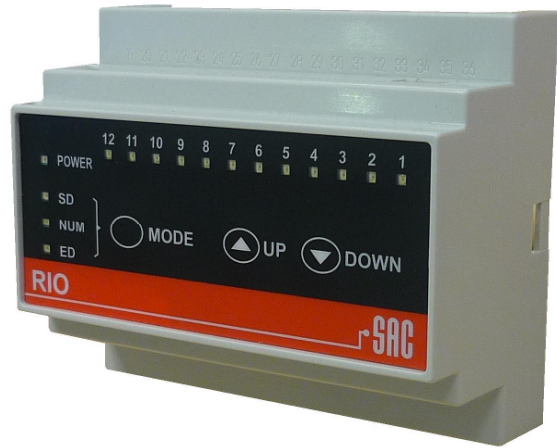
EQUIPO DE ADQUISICIÓN DISTRIBUIDA EN BUS DE PROCESO 61850
